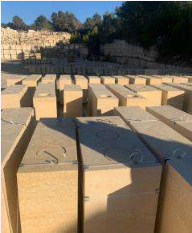
Cette maçonnerie lourde, composée de monolithes de pierre en roches calcaires de la carrière de Beaulieu est travaillée suivant un calepinage issu directement des modules d'extraction en débitages standards de la carrière du Gard; éléments déclinés sur le module standard de base de 2 mètres de long par 35 cm de large et 70 cm de haut.
